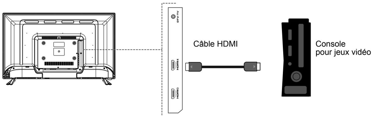
1. Connecter un câble HDMI (non fourni) à un port de sortie (OUT) HDMI de la console de jeux.
