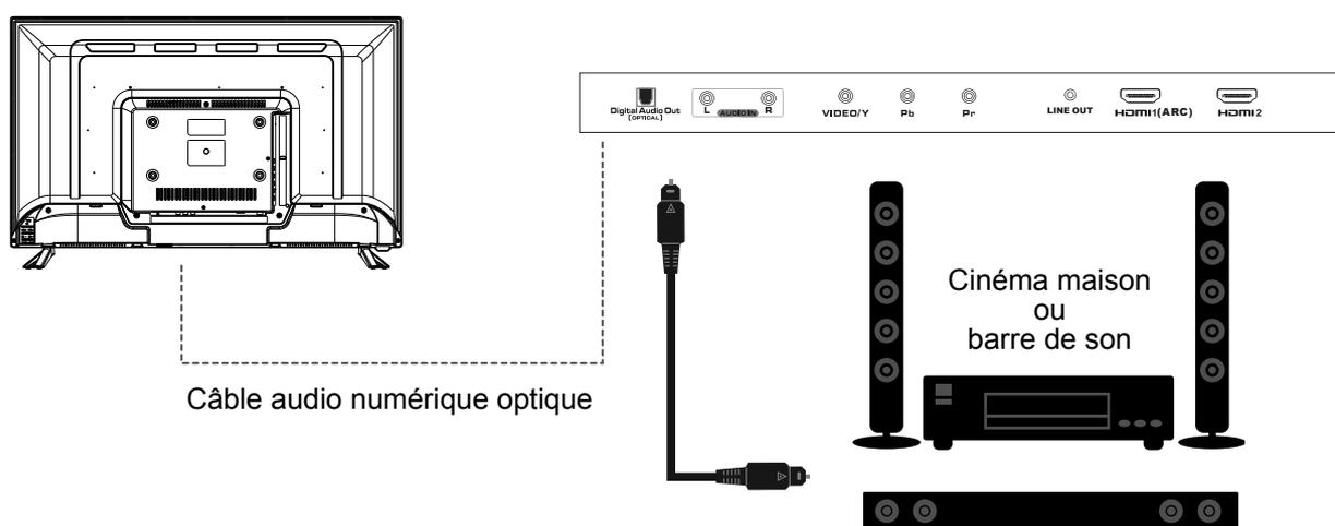
1. Connexion d'un câble audio optique numérique (non fourni) au périphérique audio.
