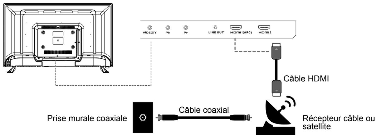
1. Connecter un câble HDMI (non fourni) à un port de sortie (OUT) HDMI du récepteur câble ou satellite.
