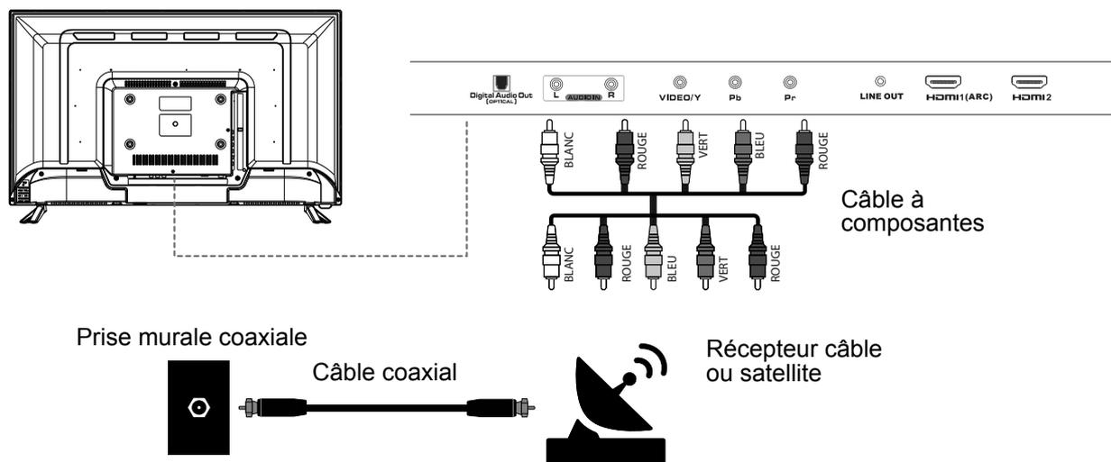
1. Brancher les connecteurs rouge, bleu et vert d'un câble à composantes (non fourni) au récepteur câble ou satellite.
