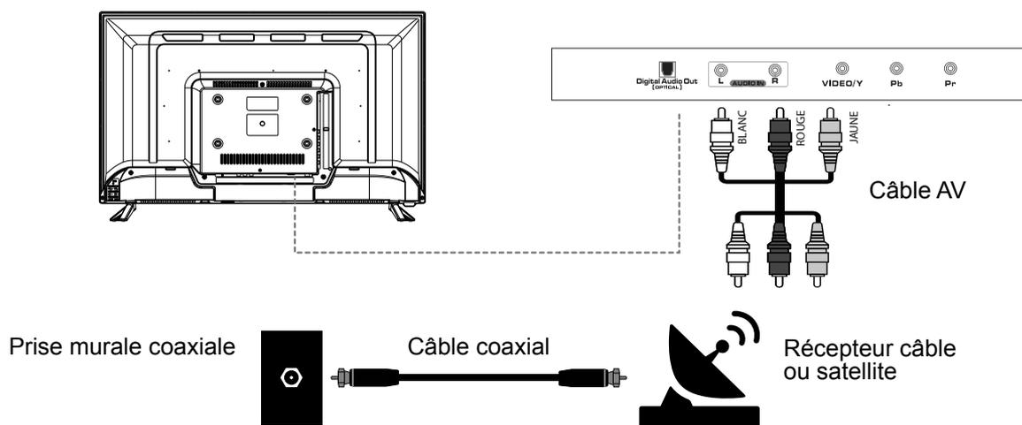
1. Connecter un câble AV (composite) [non fourni] aux prises AV du récepteur câble ou satellite.
