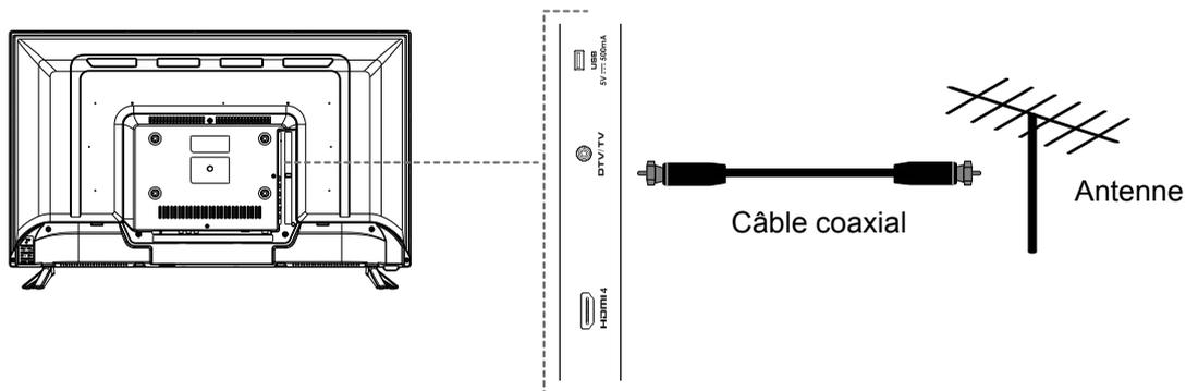
1. Connecter un câble coaxial (non fourni) à l'antenne.
