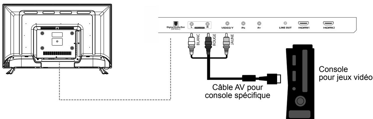
1. Connecter un câble AV (composite) [non fourni] aux prises AV de la console de jeux.
