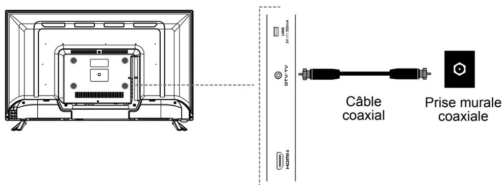
1. Connecter un câble coaxial (non fourni) au récepteur câble ou satellite.
