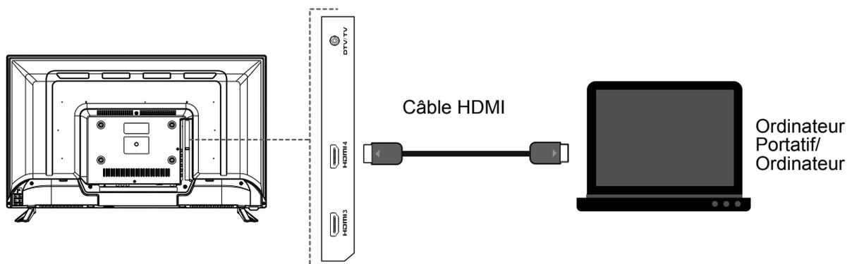
1. Connecter un câble HDMI (non fourni) à un port de sortie (OUT) HDMI de l'ordinateur portable ou d'un ordinateur.
